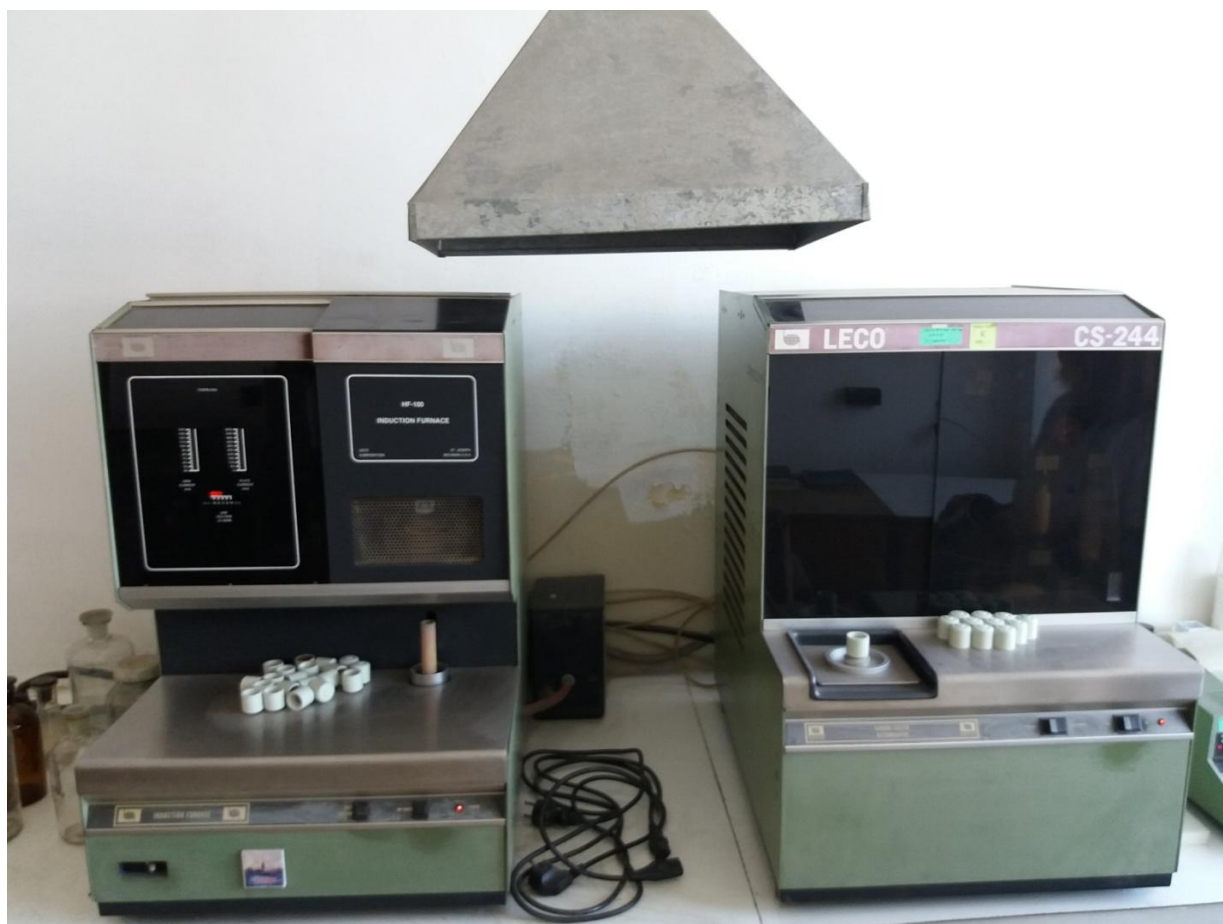
Фиг. 53. Апарат за определяне въглеродното съдържание с LECO CS-244 на прахова проба от разтворено хромово покритие с ND
