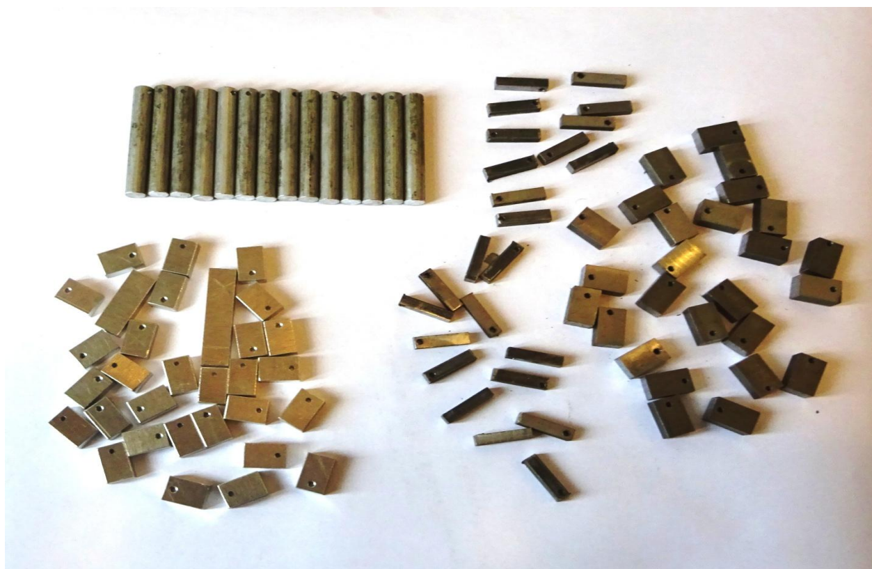
Фиг. 1а. Изготвени пробни образци от Al сплави с различни геометрични форми
