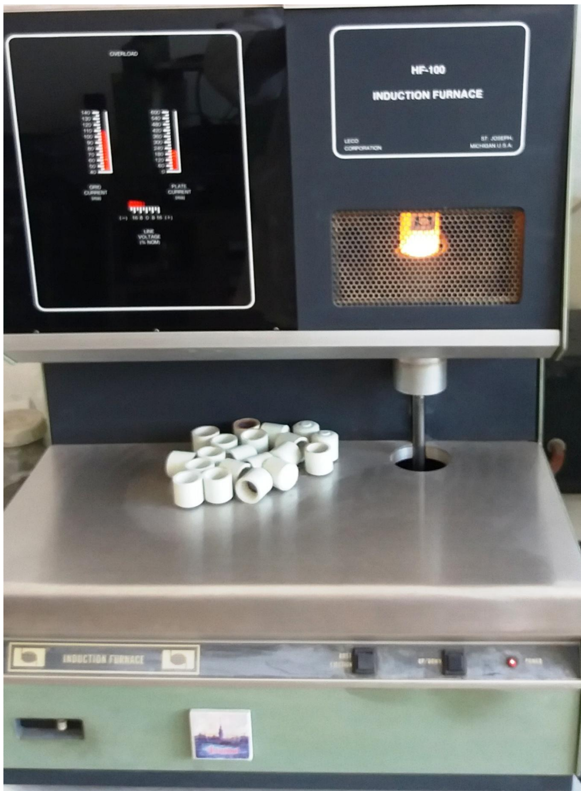
Фиг. 54. Процеса на индукционно изгаряне на изследваните проби с последващо определяне на въглерода в тегл. %
