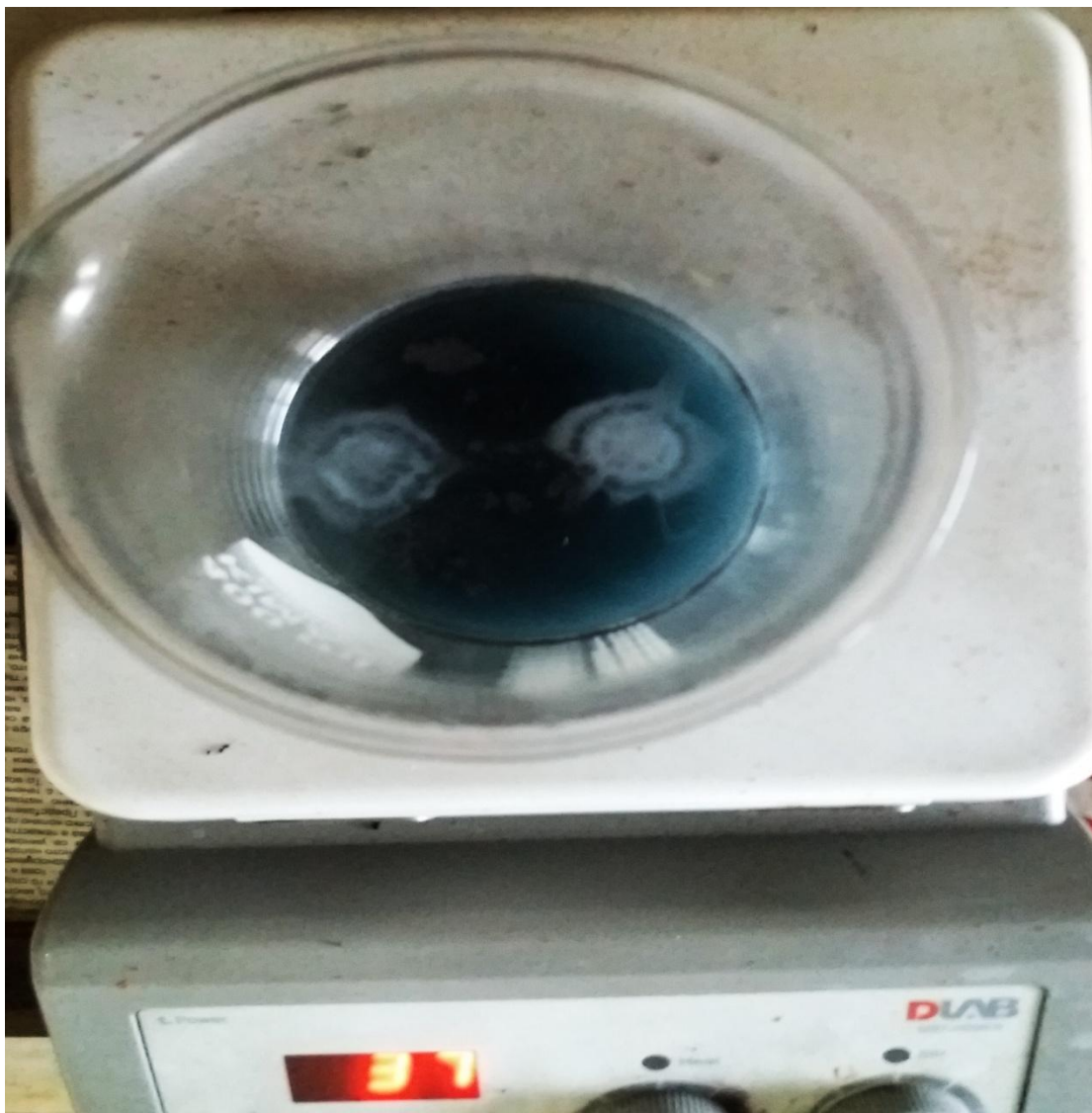
Фиг. 52. Разтваряне на покритието от хром с ND отложено върху алуминиеви сплави в разтвор на HCl
