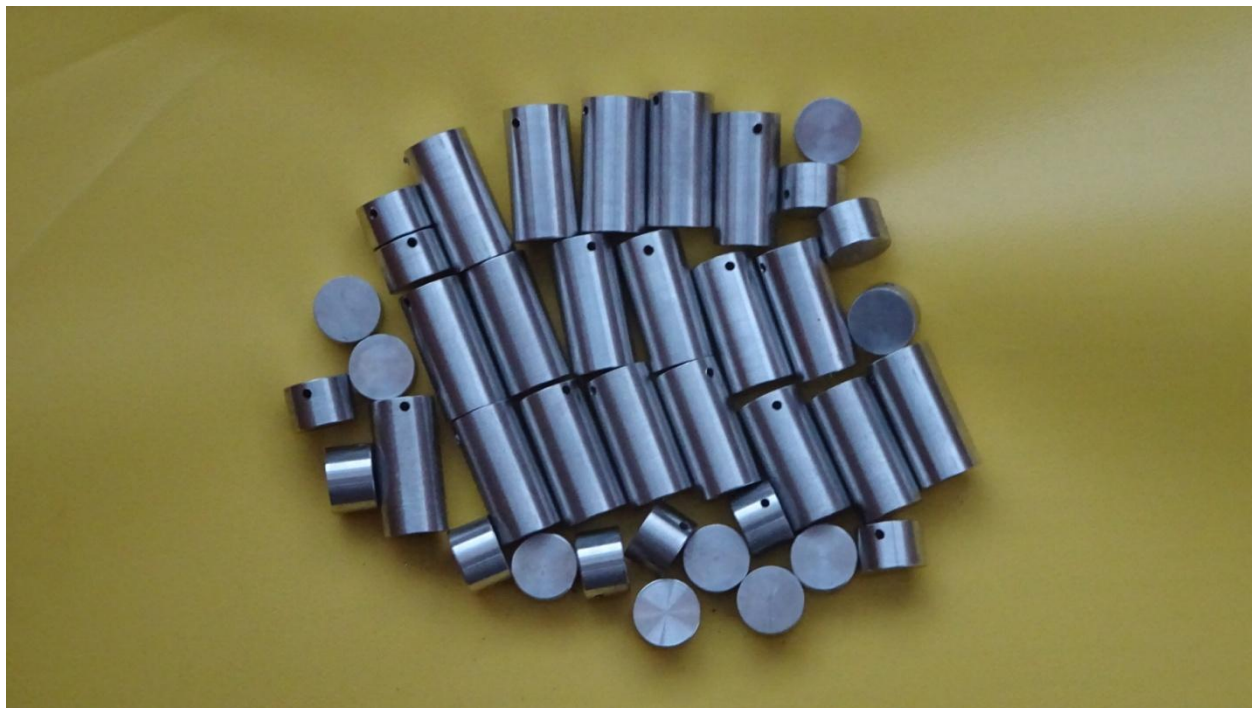
Фиг.1b. Пробни образци от Al сплави подготвени за електрохимично отлагане на хром
